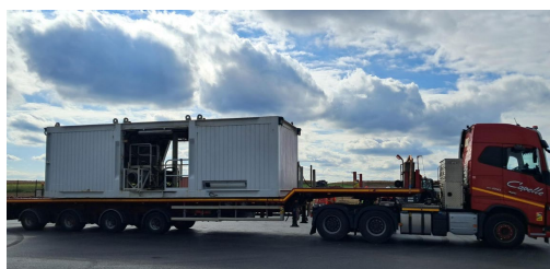
Les éléments de l'appareil de forage sont livrés en plusieurs transports puis assemblés sur le site.
