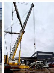
Deux à quatre grues télescopiques mobiles de 50 à 400t seront présentes sur site. Hauteur maximale : 80m.
