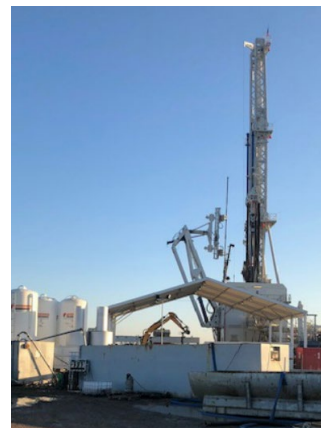
Le rig B04 mesure 52 m. Il est hydraulique et électrique.
