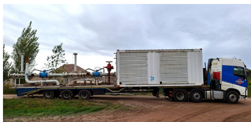
Les éléments de l'appareil de forage seront livrés en plusieurs transports puis assemblés sur le site.
